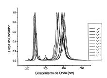
Figuras 1 (esquerda, acima) e 2: Espectros teóricos de um dímero de tetracarboxidiimido perileno cujos anéis perilenicos estão paralelos e distantes entre si 3,5Å com deslocamentos relativos ao eixo menor (esquerda) e maior (direita). Observe a oscilação em torno de 400 nm devido à existência de nodos nos orbitais moleculares dos perilenos.
