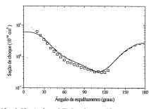
Figura 1: Seção de choque diferencial para o espalhamento e-NH<sub>3</sub> para a energia de impacto de 15 eV. Resultado presente (linha cheia), Resultados de: Pritchard *et al.*<sup>[3]</sup> (linha tracejada), Rescigno *et al.*<sup>[4]</sup> (linha pontilhada) e Alle *et al.*<sup>[5]</sup> (quadrados).
