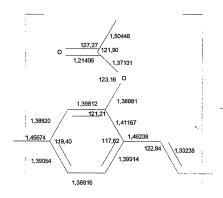
Figura 1 — Comprimentos (em Å) e ângulos de ligação (em graus) para o ACT-PPV
