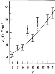
Fig.1. Seção de choque em função da massa do agregado (n = 5 a 21, ímpar, com exceção do 17)
