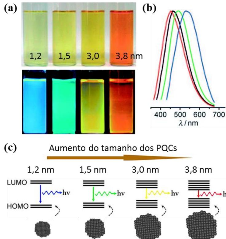
**Figura 2.7.** Fotografia das soluções de PQC sob radiação (a) visível e ultravioleta (365 nm). (b) Espectros de FL dos PQC de tamanhos 1,2; 1,5; 3,0 e 3,8 nm. (c) Representação da emissão de FL ajustável dos PQC. Figura modificada de Li et al. (2010).
