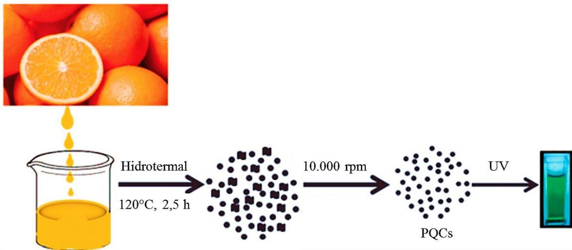
**Figura 2.10.** Esquema de síntese dos PQC's por meio do tratamento hidrotérmico do suco de laranja. Ilustração adaptada de Sahu et al. (2012).
