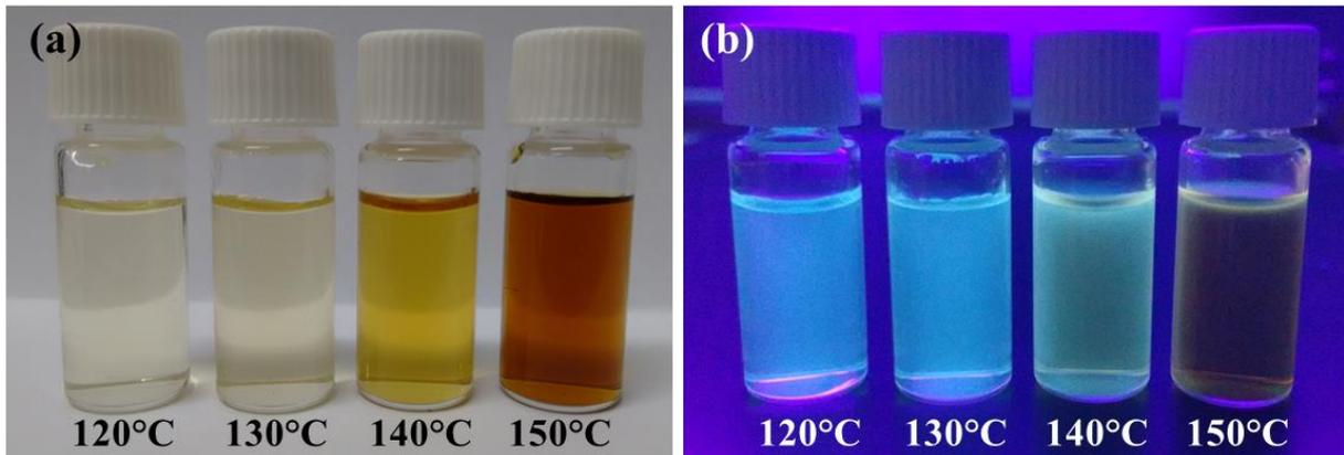
**Figura 4.1.** Imagens dos PQCs, sintetizados em diferentes temperaturas (120, 130, 140, 150°C), sob a (a) luz visível e sob a (b) ultravioleta (380 nm).
