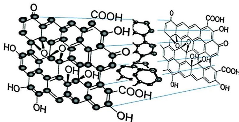
**Figura 2.2.** Representação de uma possível estrutura química dos PQC's. Adaptado de Lim et al. (2014).
