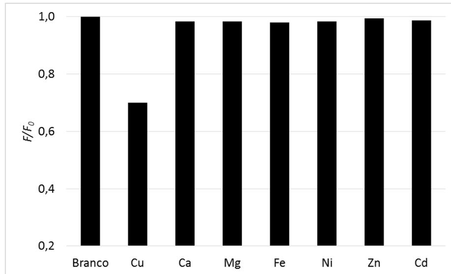
**Figura 4.8.** Emissão de fluorescência dos PQC ( $\lambda_{\text{ex}} = 400 \text{ nm}$ ) na presença de diferentes íons metálicos divalentes. Dados referentes a concentração de  $50 \mu\text{g L}^{-1}$  para cada íon metálico. Onde  $F$  e  $F_0$  são as intensidades de fluorescência na ausência e presença do íon metálico, respectivamente.
