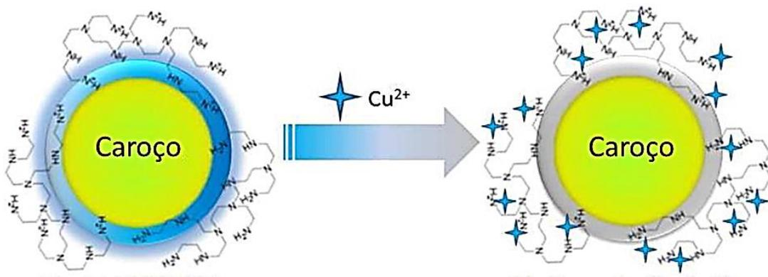
**Figura 2.13.** (a) Representação esquemática da extinção de fluorescência dos PQC's na presença do íon Cu(II).
