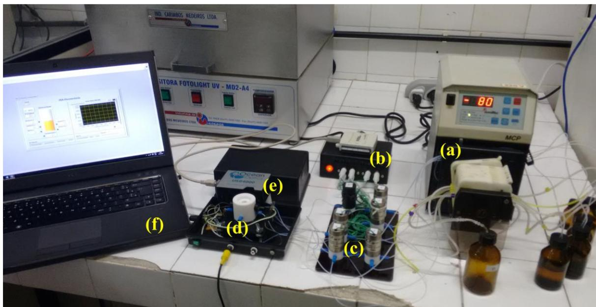
**Figura 3.2.** Fotografia do sistema automático em fluxo-batelada utilizado. (a) bomba peristáltica, (b) acionador e interface, (c) válvulas solenoides, (d) câmara de mistura, (e) espectrofluorímetro portátil, e (f) computador.
