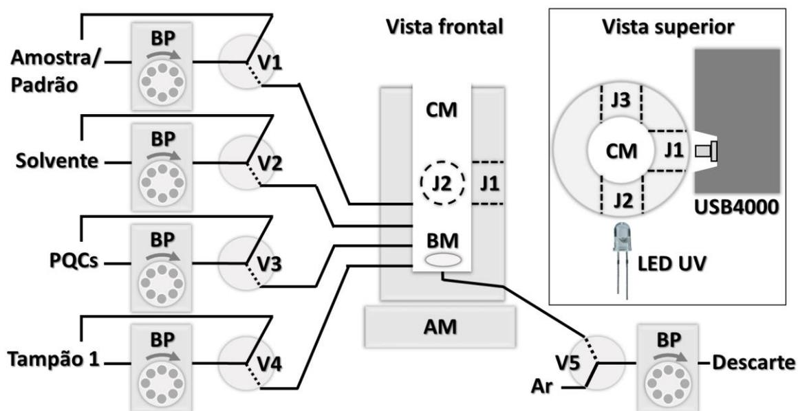
**Figura 3.9.** Diagrama esquemático do sistema automático em fluxo-batelada proposto. BP: bomba peristáltica, V: válvulas solenoides, CM: câmara de mistura, J: Janelas de quartzo; AM: agitador magnético, BM: barra magnética.
