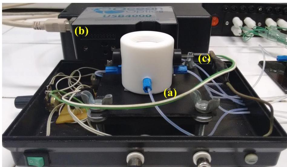
**Figura 3.4.** Detalhes do sistema fluxo-batelada. (a) câmara de mistura, (b) espectrofluorímetro e (c) LED ultravioleta.
