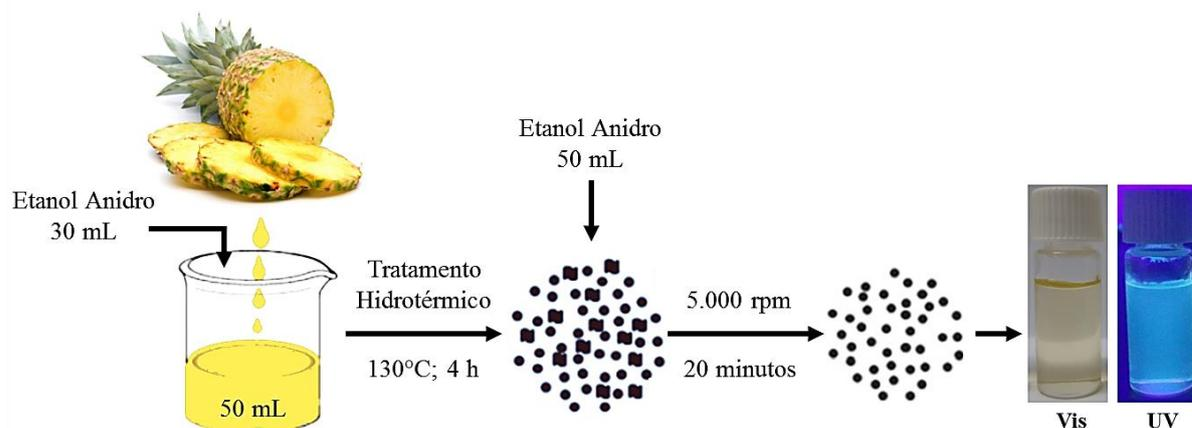
**Figura 3.1.** Esquema ilustrativo da síntese hidrotérmica de PQC a partir do suco de abacaxi.
