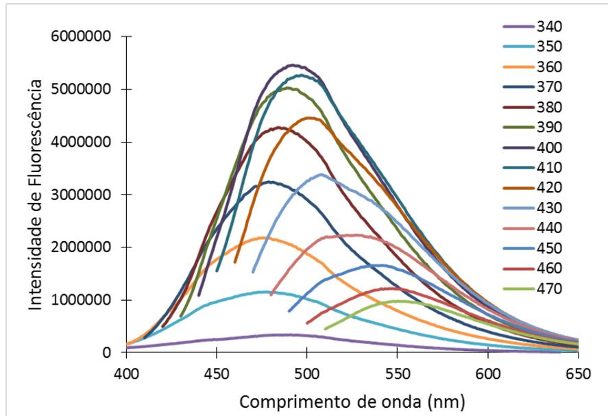
**Figura 4.5.** Espectros de emissão dos PQC's obtidos à temperatura de 140°C, excitados em diferentes comprimentos de onda (340 a 470 nm).
