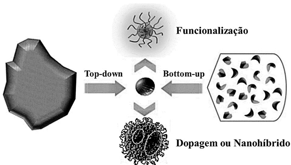
**Figura 2.9.** Diagrama esquemático da preparação dos PQC's via abordagens “*top-down*” e “*bottom-up*”, e etapas de modificações (funcionalização, dopagem ou nanohíbrido). Ilustração modificada de Wang & Hu (2014).
