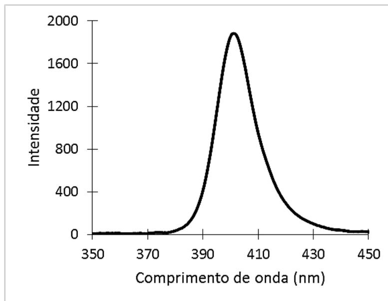
**Figura 3.5.** Espectro de emissão do LED ultravioleta.
