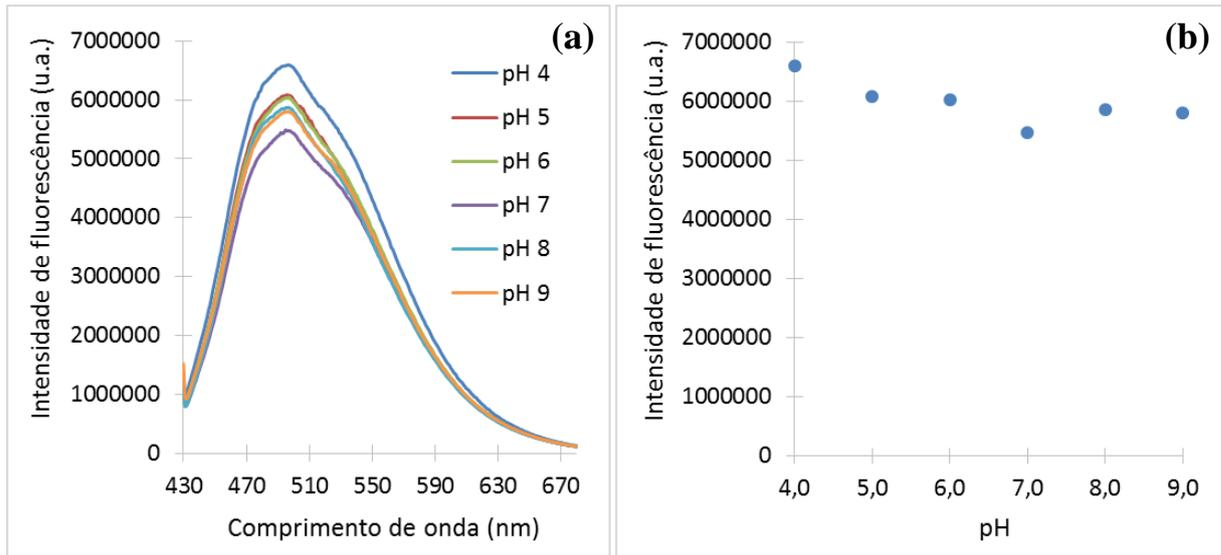
**Figura 4.4.** (a) Influência do pH nos espectros de emissão de fluorescência dos PQC. (b) Variação da intensidade de fluorescência com a mudança do pH.
