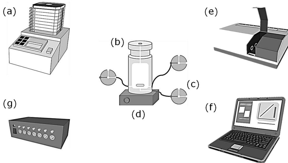
**Figura 2.16.** Esquema ilustrativo dos principais componentes do FBA. (a) bomba peristáltica, (b) câmara de mistura, (c) válvulas solenoides, (d) agitador magnético, (e) sistema de detecção, (f) computador e (g) acionador de válvulas.
