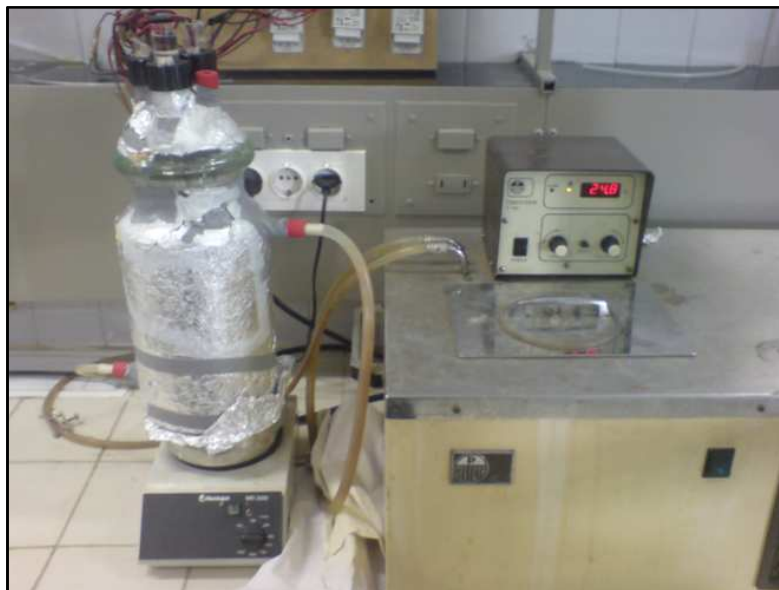
Figura 6. Reator utilizado no processo foto Fenton.
