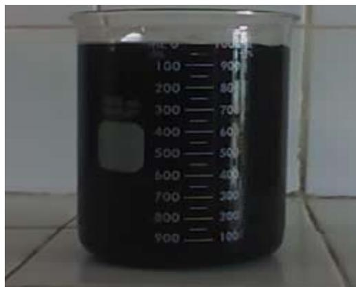
Figura 4.4 Lodo anaeróbio utilizado para inoculação do reator na primeira etapa da pesquisa.
