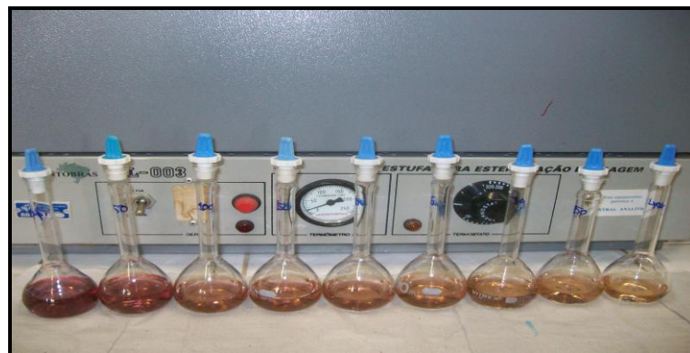
Figura 4 Esquema da curva do óleo essencial de canela com o radical DPPH.
