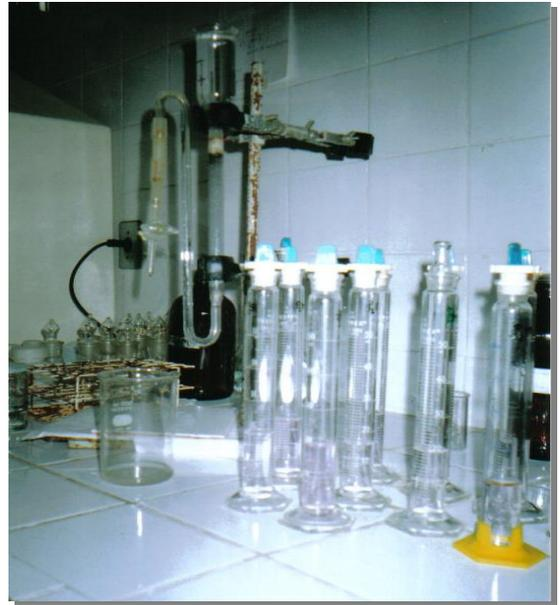
Análise de nitrato ( $\text{NO}_3^-$ ) utilizando a coluna de Cádmi
