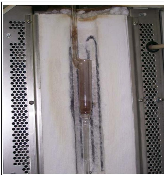
**Figura 3.6** - Reator acoplado ao forno
