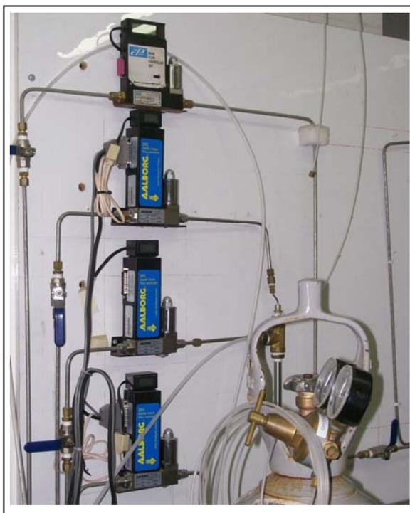
**Figura 3.4** - Válvulas controladoras de vazão
