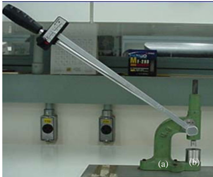
Figura 7: Prensa (a) e forma (b) labmade usada para prensar os comprimidos.
