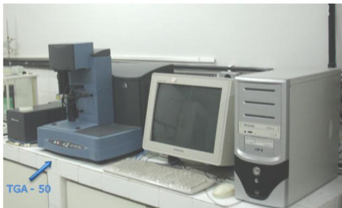
**Figura 7-** Termobalança SHIMADZU modelo TGA-50 e periféricos
