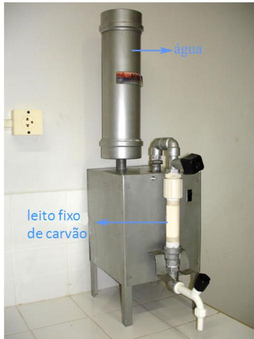
**Figura 10-** Coluna de leito fixo
