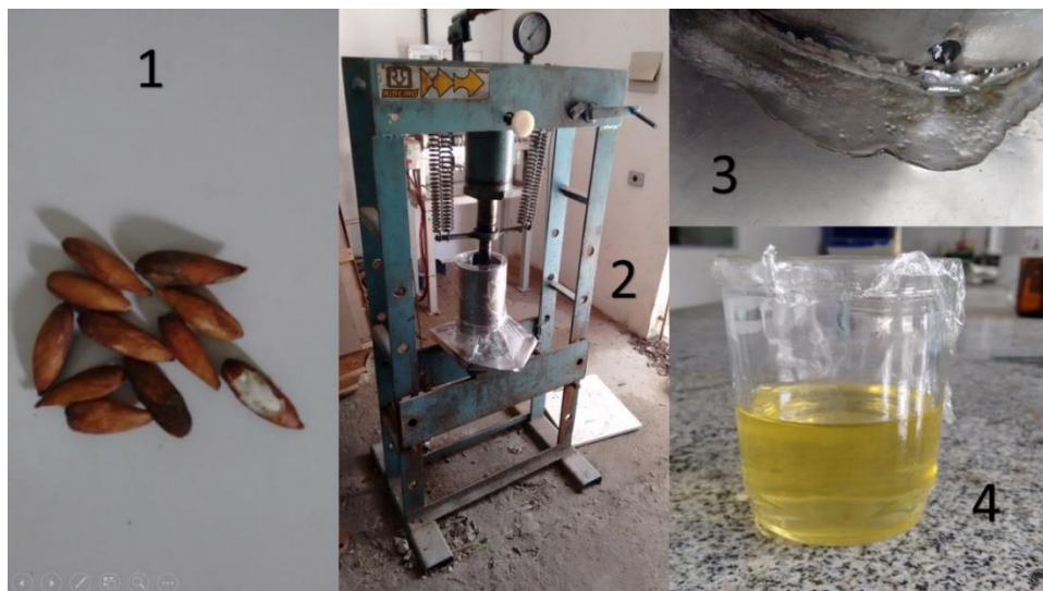
Figura 35 – Processo de extração do óleo. (1) quebra das amêndoas, (2) prensagem (3) obtenção do óleo e (4) óleo filtrado.
