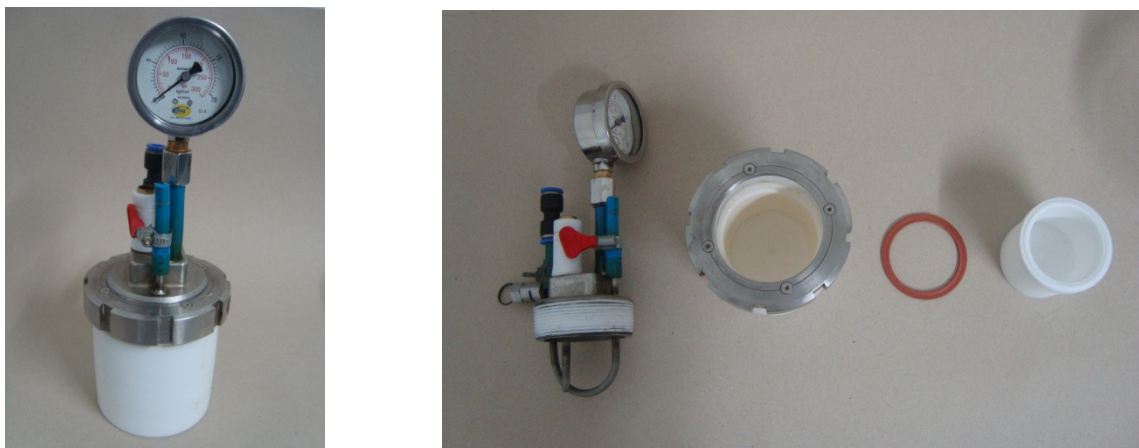
Figura 10 – Partes que compõe a célula do reator hidrotermal de micro-ondas.
