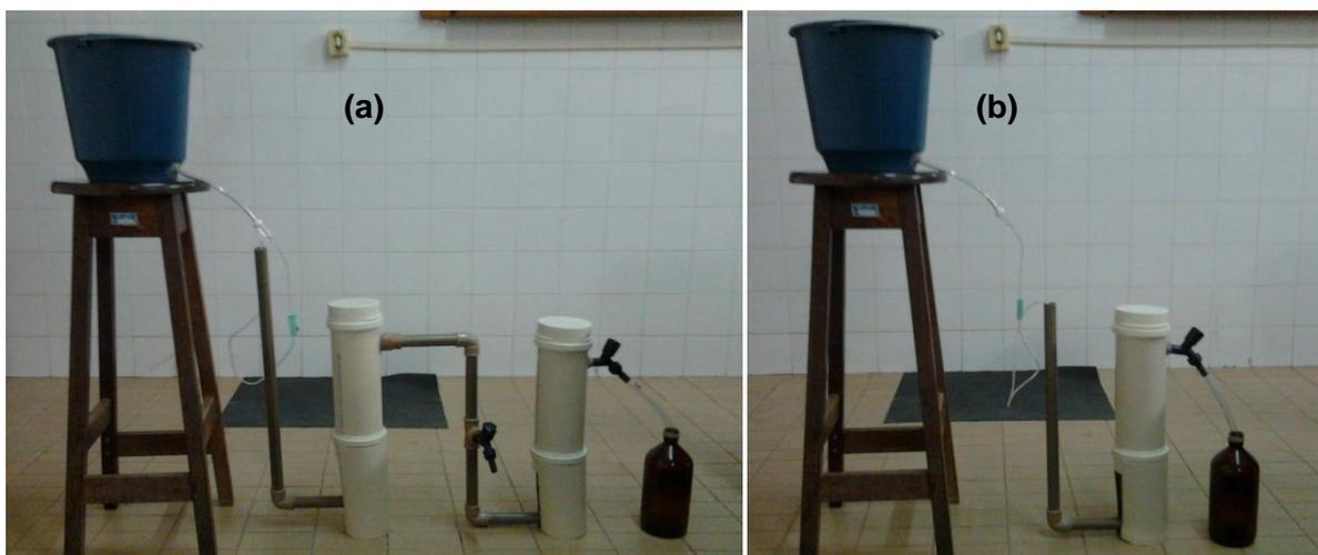
**Figura 3** – Reatores utilizados no experimento de adsorção: (a) em série e (b) aerado
