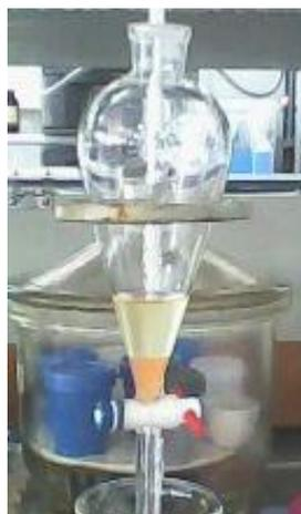
**Figura 5.24. Produto da transesterificação com  $K_2CO_3$  (TFK calcinado), utilizando 0,5 % de catalisador.**
