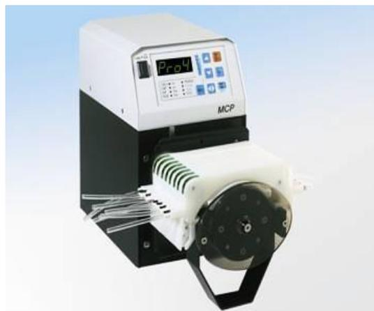
**Figura 2.3** - Fotografia de uma bomba peristáltica.
