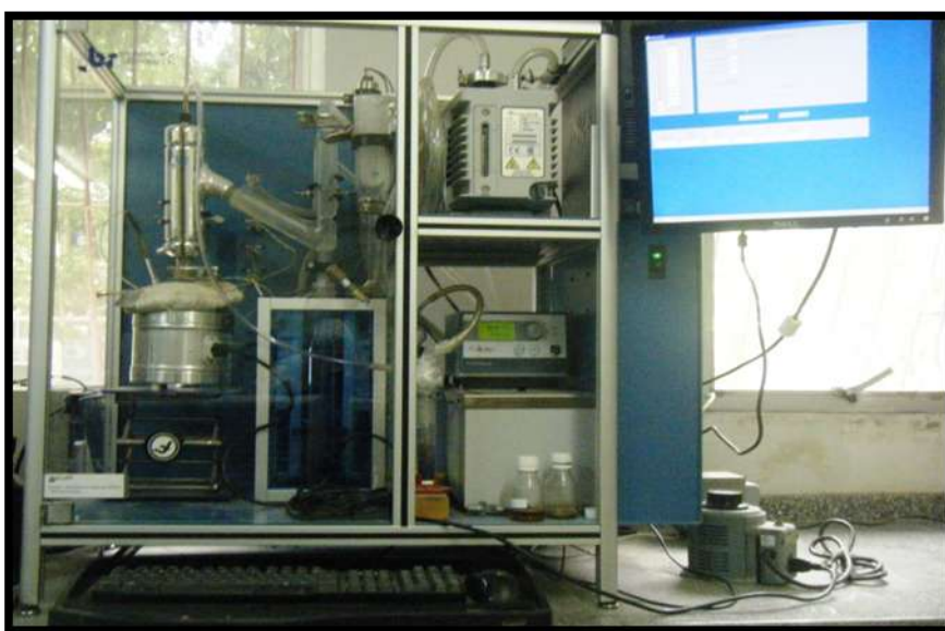
Figura 4.2 – Sistema utilizado para degradação das graxas lubrificantes.
