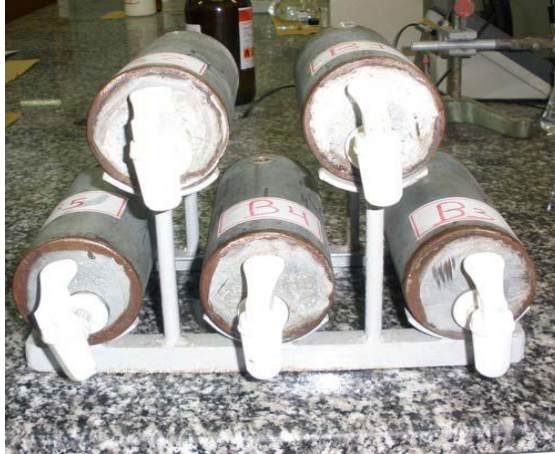
Figura 17. Tanques de aço carbono utilizados para o armazenamento das amostras de biodiesel de soja aditivada e não aditivada com antioxidantes.
