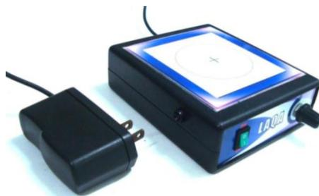
**FIGURA 2.4.** Agitador magnético utilizado no LFB.
