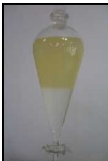
Figura 4.3 – Processo de lavagem do biodiesel metílico de licuri.
