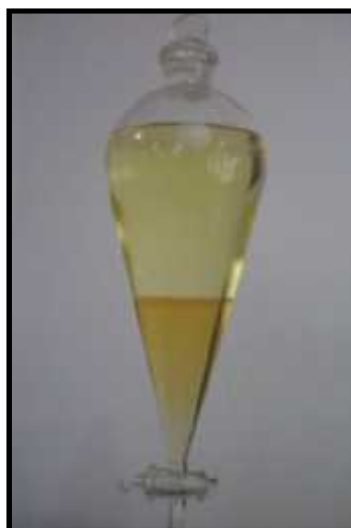
Figura 4.2 – Separação da glicerina e do biodiesel metílico de licuri.
