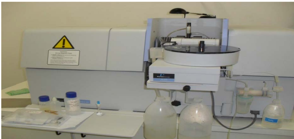
Figura 7. Espectrômetro de absorção atômica em forno de grafite modelo AAnalyst 600 da Perkin-Elmer.
