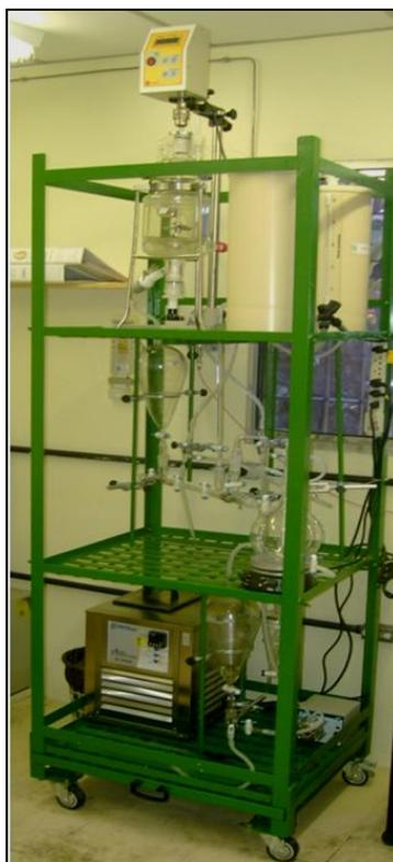
**Figura 4.1** – Planta piloto utilizada para produção do biodiesel de girassol, localizada no Laboratório de Combustíveis (LAC) da UFPE.
