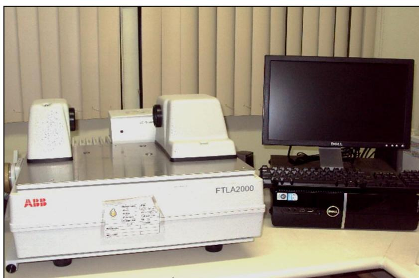
**Figura 4.2**– Espectrofotômetro Infravermelho FT-IR (FTLA 2000-160) da Bomen<sup>®</sup>.
