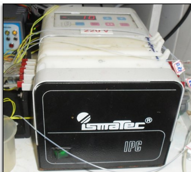
Figura 36: Bomba peristáltica Ismatec modelo IPC, com doze roletes e oito canais.
