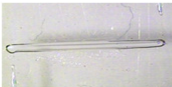
Figura 24: Obstrução ocorrida ao se utilizar uma única transparência na fotolitografia.
