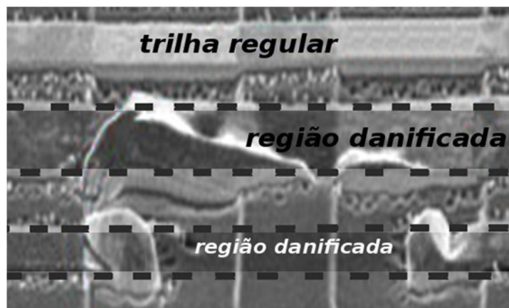
Figura 7: Imagem ilustrativa do dano provocado por um único grão de poeira na superfície de um "CHIP"[58].
