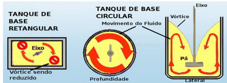
Figura 57: Ilustração do efeito de vórtice em tanques diferentes.
