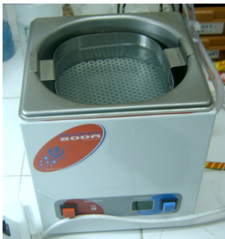
Figura 34: Aparelho de banho ultrassônico utilizado no processo de revelação do sistema.
