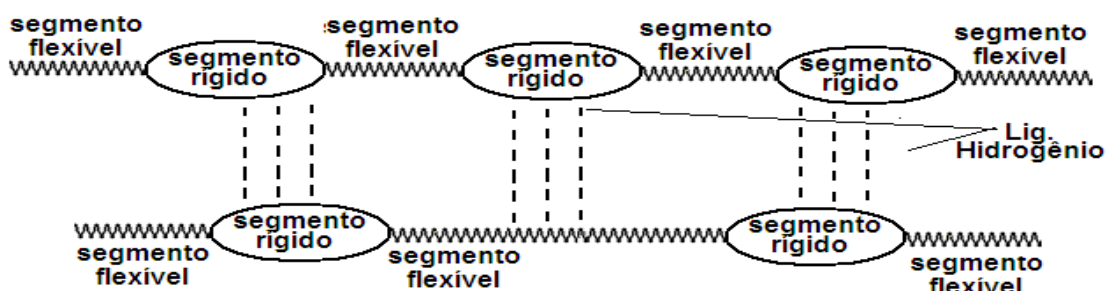
Figura 18: Interação intermolecular entre domínios distintos de uma possível cadeia de PU, causando com isso a mistura de fases.
