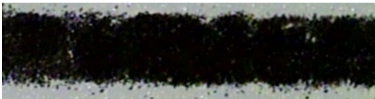
Figura 26: Foto de uma linha impressa na transparência utilizada como máscara de revelação na fotolitografia profunda em UV da resina baseada em UA.
