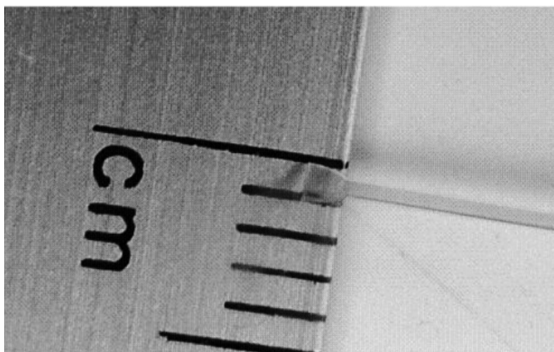
Figura 59: Foto ampliada do fio de nylon® com diâmetro 0,4mm utilizado como haste misturadora no \mu FBA.
