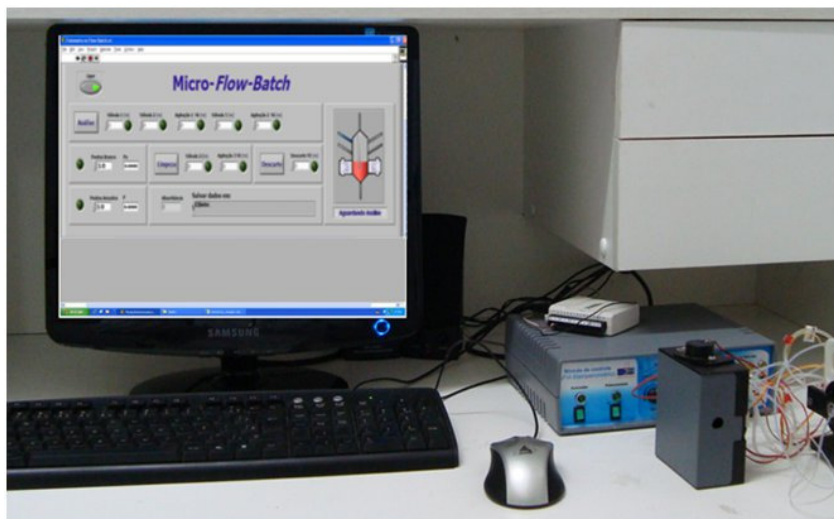
Figura 65: Foto do sistema \mu FBA em uso, a caixa onde se encontra a câmara de mistura, e detecção permanece fechada durante a operação. Observa-se a janela da interface gráfica de gerenciamento, desenvolvida em Labview® 5.1.
