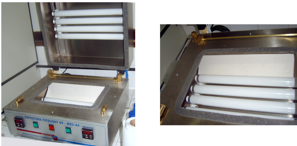
Figura 33: Expositora Fotolight utilizada para polimerização do substrato, com tampa superior aberta à esquerda e parte inferior em detalhe à direita.
