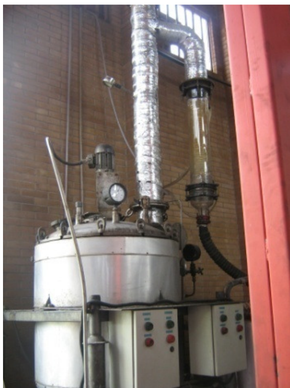
Figura 4.7 . Processo de secagem do Biodiesel
