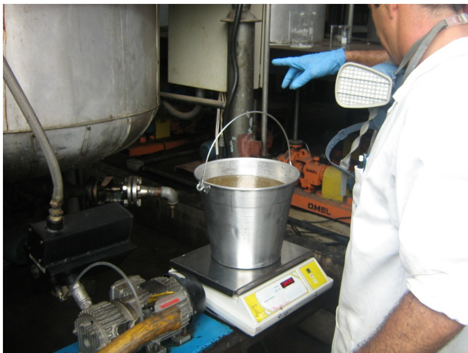
Figura 4.8. Preparação do Metóxido
