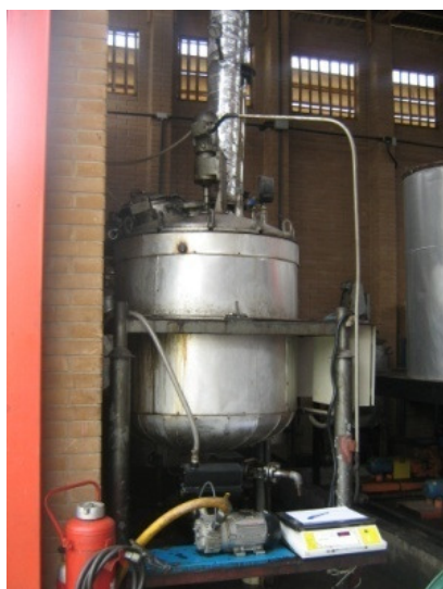
Figura 4.3. Reator Inox de 200 litros
