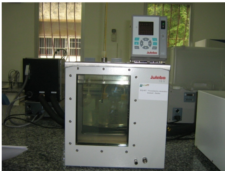
Figura 4.14. Viscosímetro Cinemático Manual, marca Julabo, modelo ME 18V
