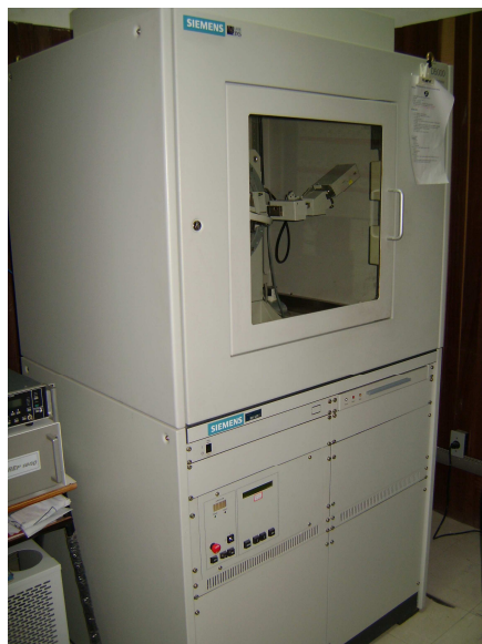
Figura 17. Difratormetro utilizado para as análises de DRX.
