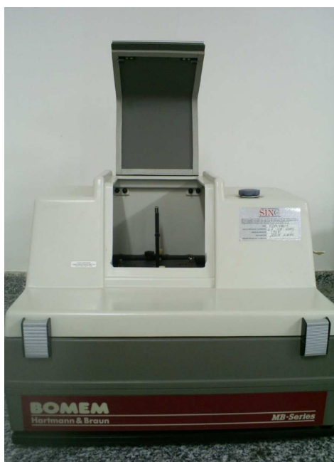
Figura 18. Espectrofotômetro utilizado para as análises de IV.
