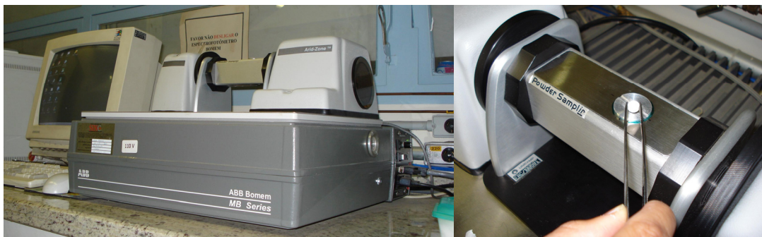
Figura 3.1 (a) equipamento ABB-BOMEM; (b) suporte para análises de sólidos
