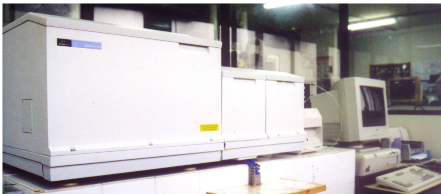
Figura 3.2 Espectrômetro com Transformada de Fourier Perkin Elmer Spectrum GX.
