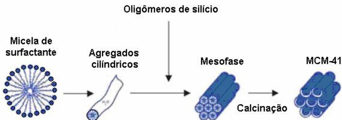
Figura 6. Mecanismo de síntese da fase MCM-41.
