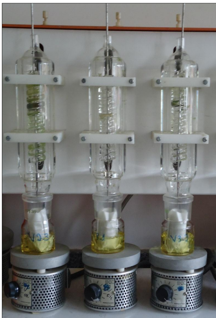
Figura 3.7: Processo de extração de cera de plumas de algodão com álcool em extratores de Randall.
