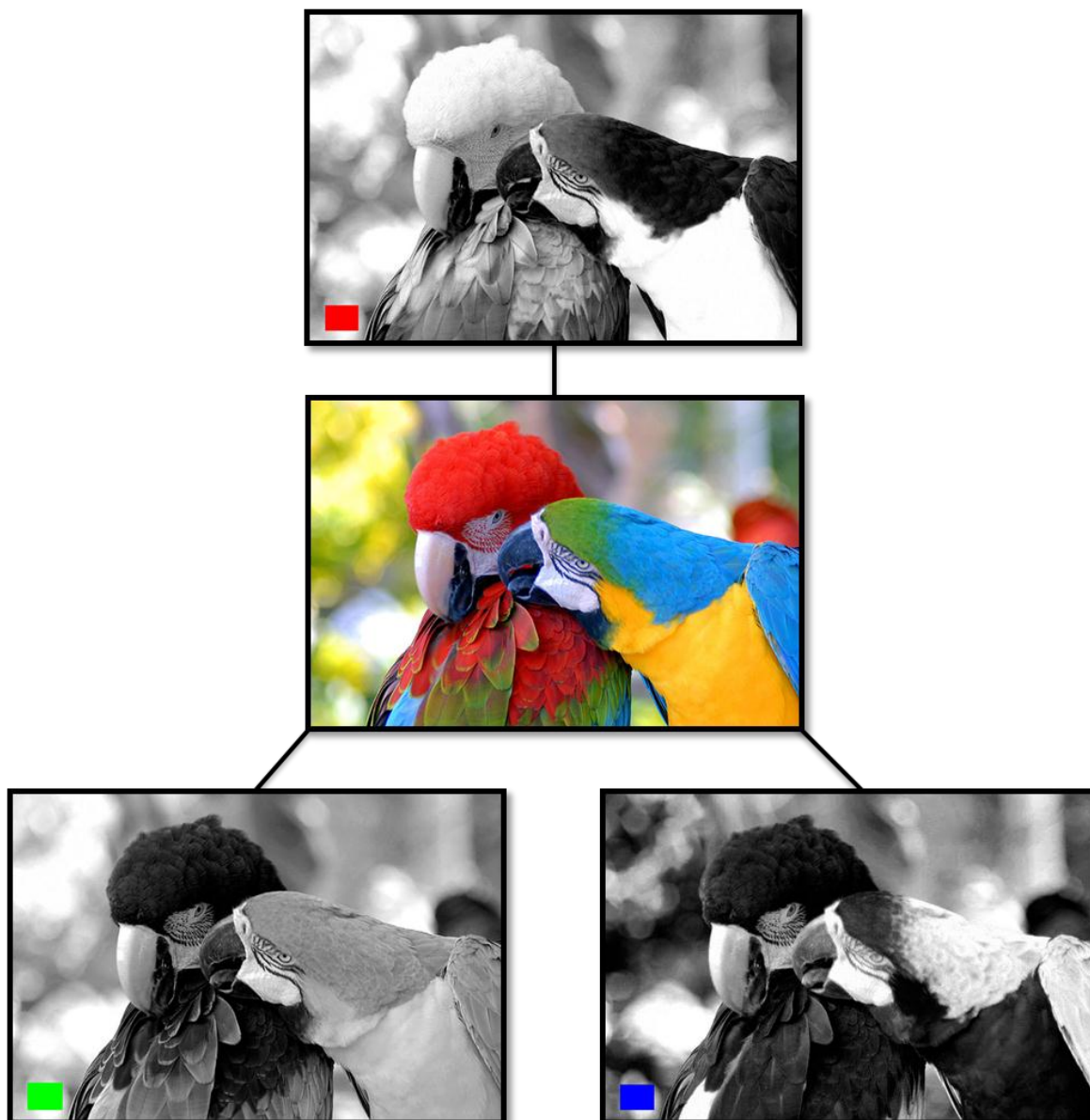
Figura 2.6: Os três planos monocromáticos de uma imagem, separadamente, e a imagem colorida resultante da composição desses três planos.
